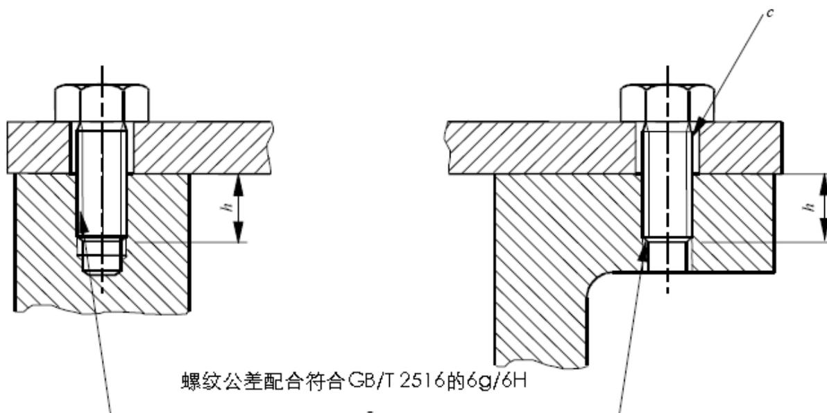
$h \geq$  紧固螺栓的螺纹外直径；
