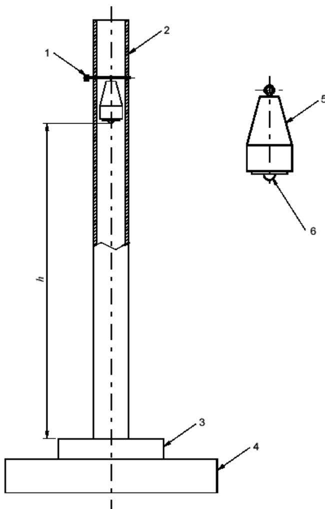
1—调整高度用螺栓； 2—塑料导管； 3—试品； 4—钢座(质量 $\geq 20\text{kg}$ )； 5—钢质锤体； 6— $\Phi 25\text{mm}$  锤头； h—坠
