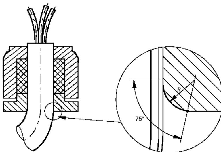
图 A.2 可弯曲电缆进线口圆角
